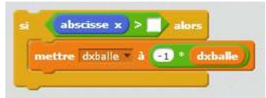
5) Complétez le script de la balle pour qu'elle rebondisse également sur le mur de gauche et le plafond (en utilisant l'ordonnée y)
