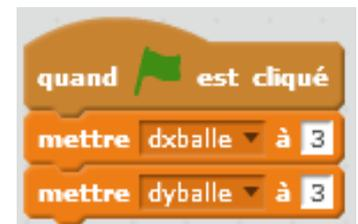
2) Dans le script de la balle, ajoutez les blocs qui permettent de déplacer la balle dès que le programme est lancé.
