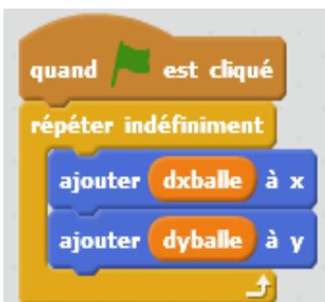
Lorsque la balle touche les murs ou le plafond, elle doit rebondir. Un rebond sur le mur de droite va correspondre à une inversion du sens de déplacement que l'on simulera par un échange de signe de la variable *dxballe*.
